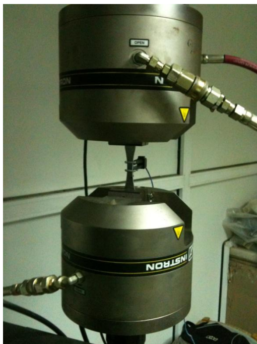
Σχήμα 6: Πειραματική διάταξη λίγο πριν την έναρξη της δοκιμής κόπωσης.
