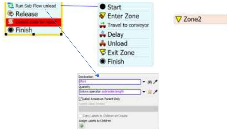
Σχήμα B.39: Κλήση Sub Flow για εκφόρτωση κιβωτίων στην παλέτα
