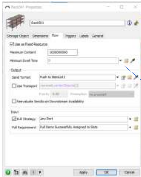
Σχήμα A.6: Ρύθμιση πεδίων καρτέλας Flow του αντικειμένου Rack
