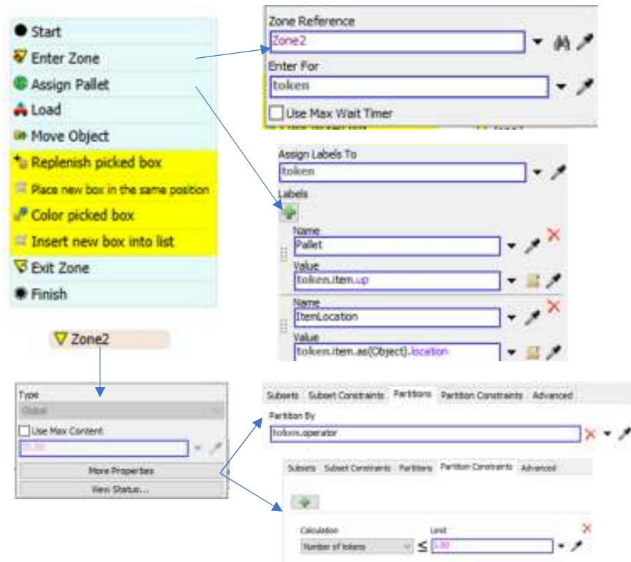
Σχήμα A.32: Εντολές Process Flow για ρύθμιση και κλήση Zone2
